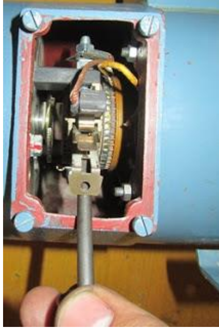
شكل رقم ٤٣: الضغط على زمبرك (باي) تثبيت الفرش الكربونية
