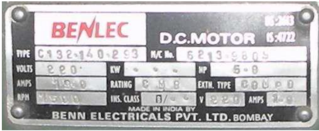
شكل رقم ٦: لوحة بيانات محرك تيار مستمر
