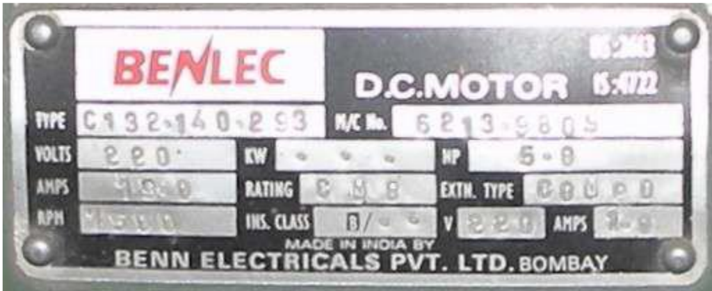
شكل رقم ٤٠: لوحة بيانات محرك تيار مستمر
